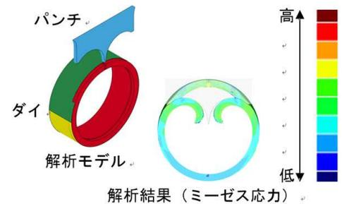
図 3 塑性加工シミュレーション
