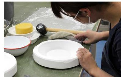
図3 鑄込み技法による試作
