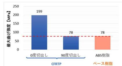
図4 曲げ強度試験の結果
