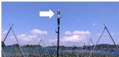
図3 超音波スピーカー（矢印の先端がスピーカー）
