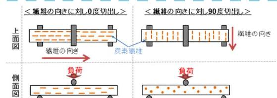
図3 繊維方向と曲げ強度試験のセット方法
