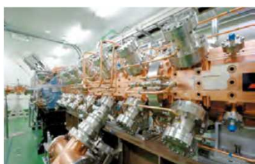
ホウ素中性子捕捉療法 (BNCT) に用いられる小型直線加速器
