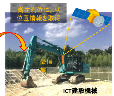
3次元設計 データを建設 機械に搭載
