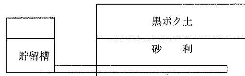
図1. 蒸発散槽の基本構造
