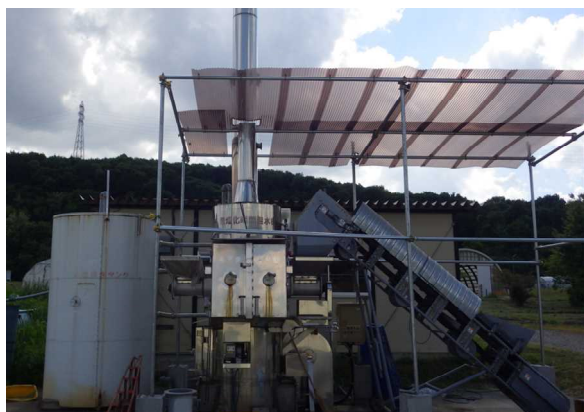
図 1 無煙化小型焼却炉
