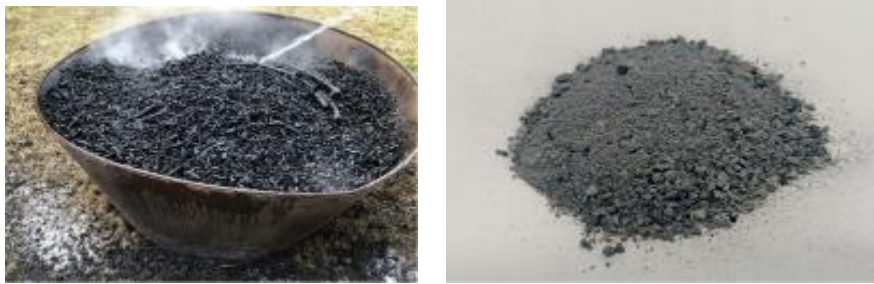
図2 試験に使用した多孔質資材（左：剪定枝炭化物、右：石炭燃焼灰）
