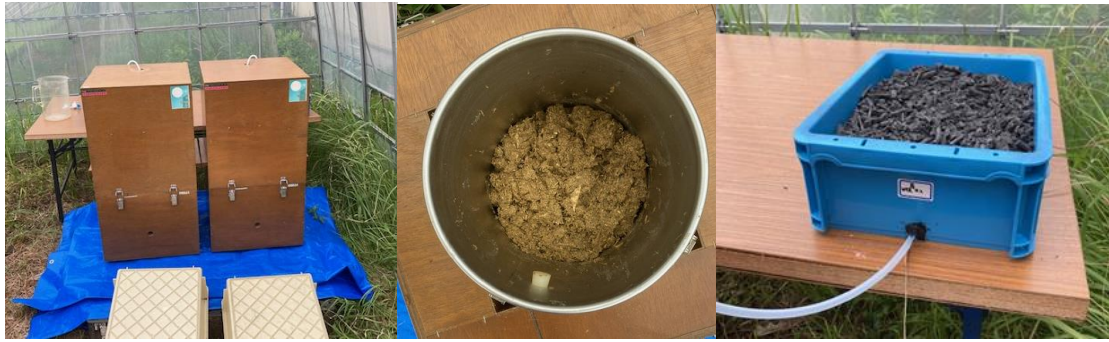
図1 小型堆肥化装置（左）と家畜ふん充填部分（真ん中） 小型簡易脱臭槽（右）
