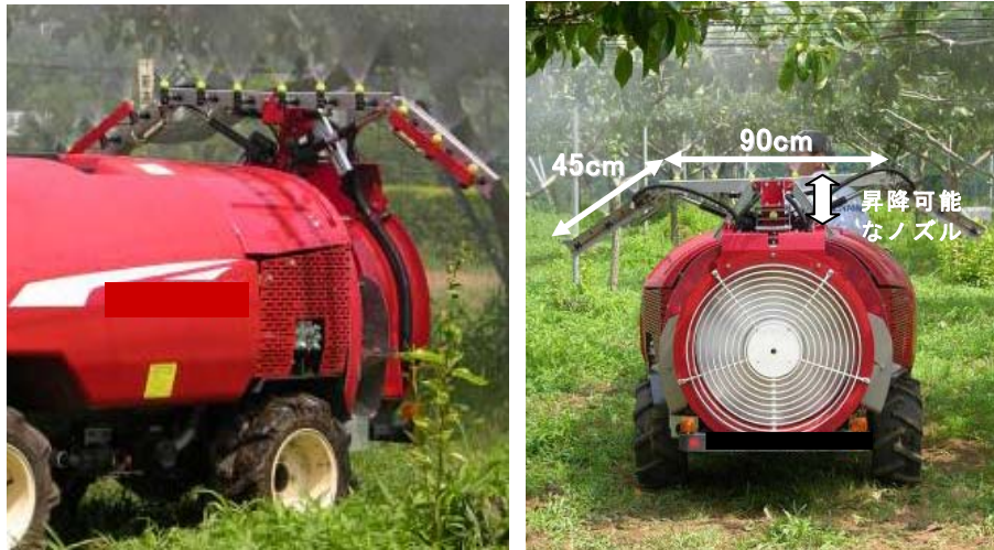
図1 ドリフト低減型SSと散布ノズルの形状
