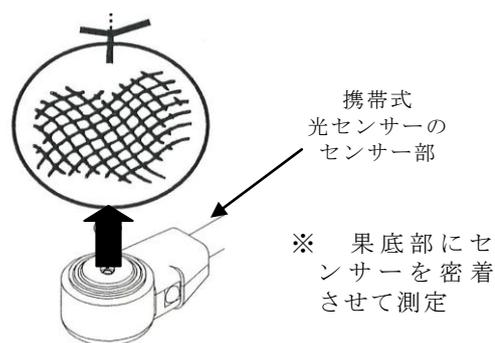
図2 光センサーでの糖度の測定法
