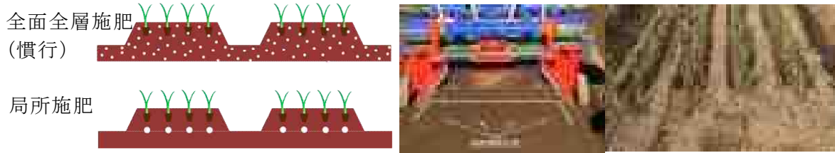
図1. 局所施肥のイメージと畝立てと同時に局所施肥機
