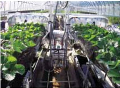
図1 開発中の温湯散布装置
