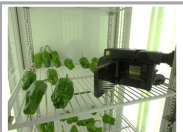
光量と温度を設定した人工気象器内で果実の表面温度を測定
