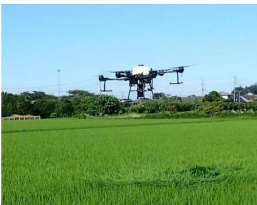
図1 ドローンによる追肥作業の様子
