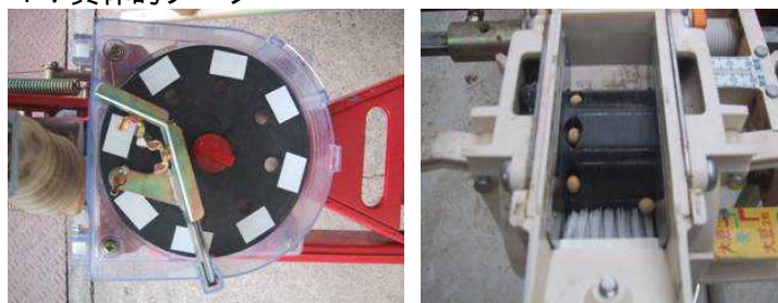
図1. 傾斜回転目皿式播種機 (左) および横溝ロール式播種機 (右)
