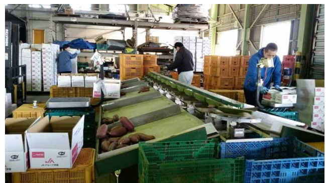
写真1 重量選別機を活用したカンショ出荷作業の様子
