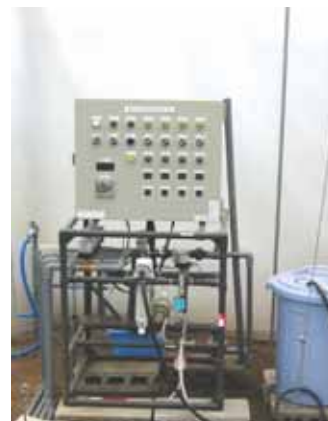
図2 養液土耕装置
