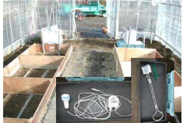
温水循環装置の構造とヒーター、バスポンプ
