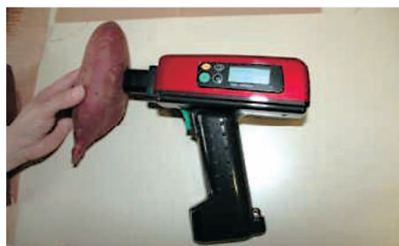
写真1 「ベニアズマ」の非破壊測定の様子
