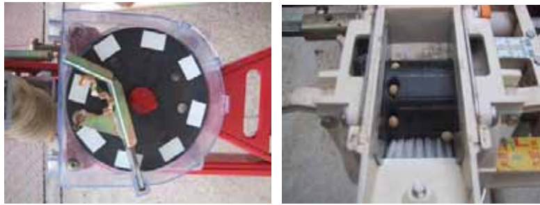
図- 1 - 14 傾斜回転目皿式播種機（左）および横溝ロール式播種機（右）
