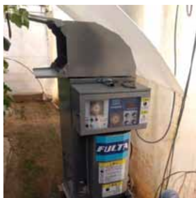
写真2 炭酸ガス施用機
