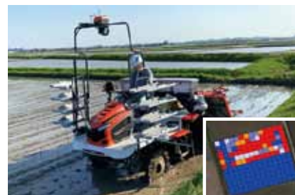
センシングデータに基づく最適な施肥量の田植え同時施肥
