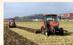
ロボットトラクタ(前方)と有人トラクタ(後方)との協調作業
