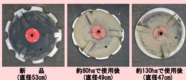
図38. 作溝ディスクの磨耗
