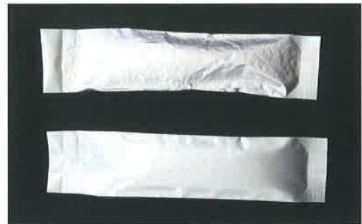
写真1 お茶の窒素置換包装例 (上:脱気のみ、下:窒素ガス充填)
