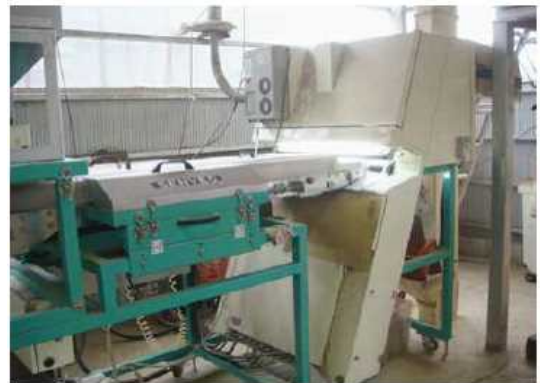
図4 従来のカラーセンサーに加えて近赤外センサーによる分別機能も有する色彩選別機
