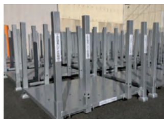
写真2 組立式で荷崩れしに くいポストパレット の外観
