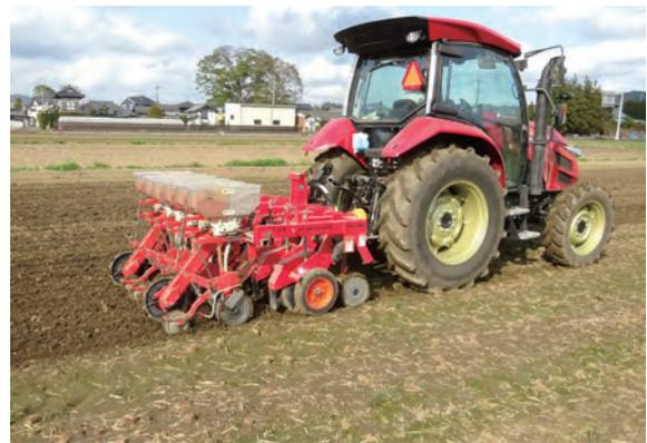
写真1 不耕起播種機を使用した乾田直播作業
