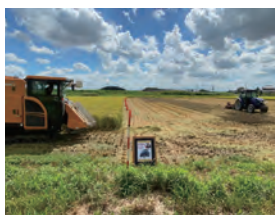
写真4 無人トラクタと有人コンバインの協調作業 ・人件費22%削減 ・早期すき込み効果で基肥量11%削減
