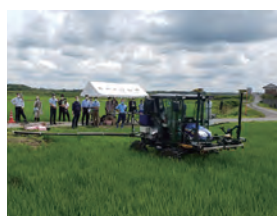
写真3 生育量をリアルタイムにセンシングしながら可変施肥を実施 ・追肥量19%削減 ・収量4%増加
