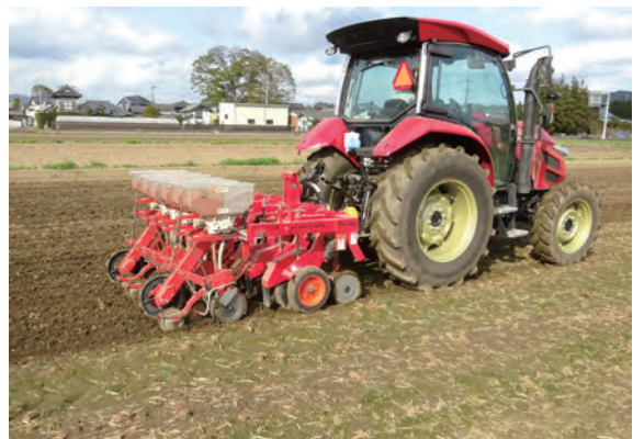
写真1 不耕起播種機を使用した乾田直播作業
