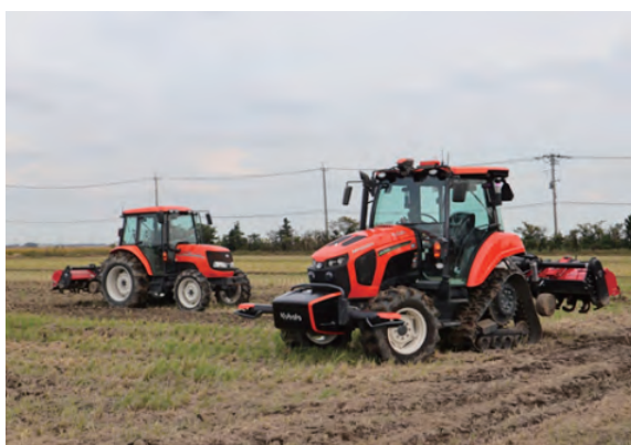
写真1 導入されたスマート農機（ロボットトラクタ）
