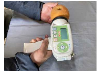
図1 携帯型分光計による果皮のクロロフィル含量計測
