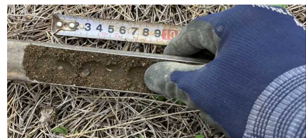
図4 硬化した土壌の確認方法 ハンドオーガーで採取した土壌を指で押し、指あとの有無を確認する。
