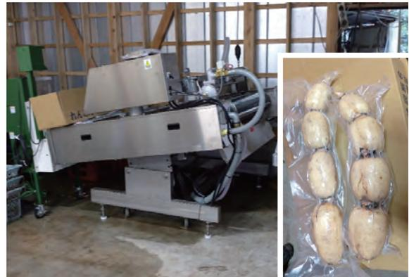
写真1 レンコンの真空包装機（左）と試作品（右）
