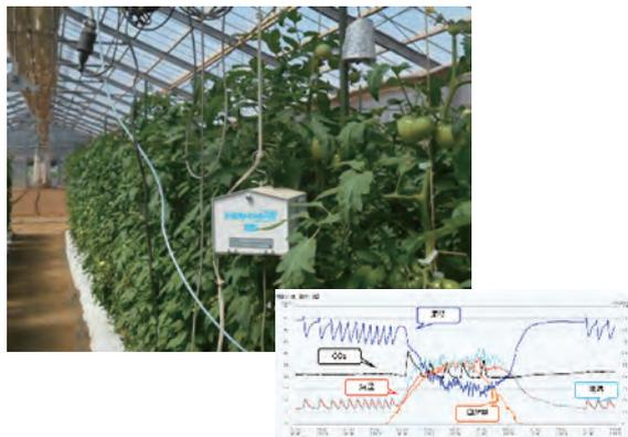
写真3 環境測定装置と実際の測定画面
