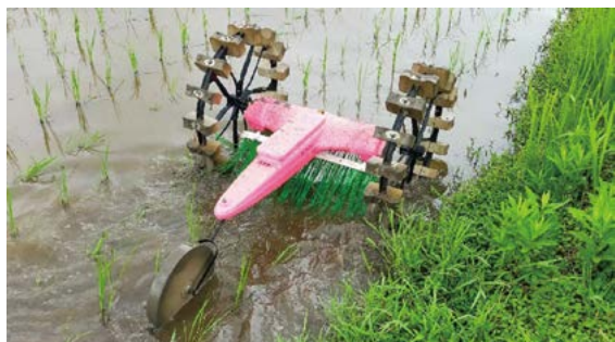
図2 稼働中のGNSS制御抑草機
