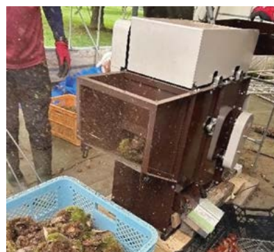
図3 イガ剥き機によるイガ剥き
