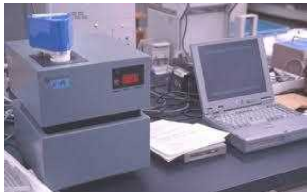
図 31 ラピッド・ビスコ・アナライザー（RVA） （茨城県農業総合センター生物工学研究所）
