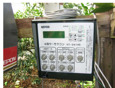
図Ⅱ-2-7 多段式サーモ装置
