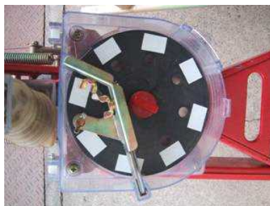
図-Ⅲ-1-14 傾斜回転目皿式播種機（左）および横溝ロール式播種機（右）
