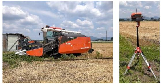
図1 ロボットコンバインと基地局
