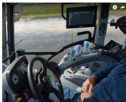
図2 自動操舵による代掻き作業
