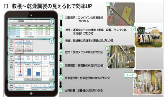
図1 タブレットによる作業状況のモニタリング
