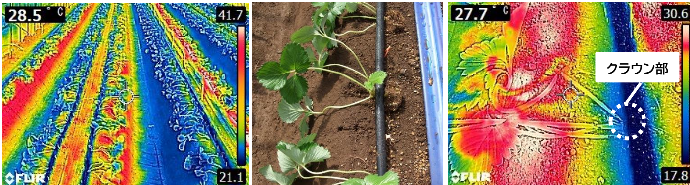
(写真) サーモカメラを用いて測定したク라운冷却処理時の表面温度
