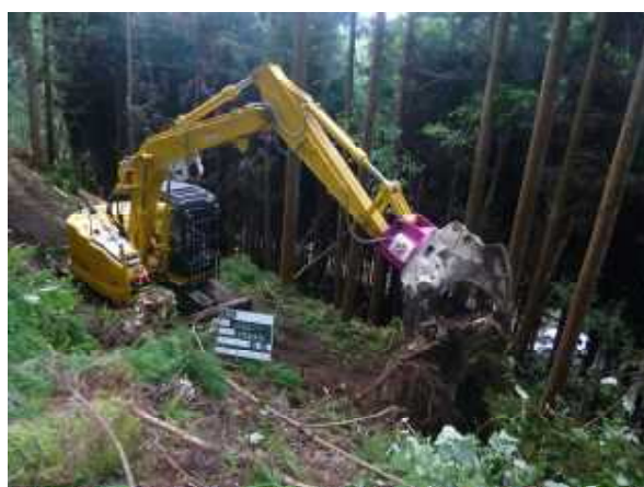
写真-2 フェラーバンチャ付ザウルスロボ
