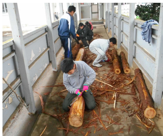
写真-2 ナタを使った皮むき作業
