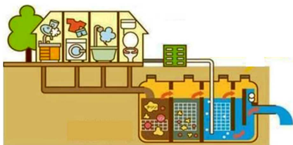
高度処理型浄化槽 (窒素・りんをより多く除去する浄化槽) のしくみ
