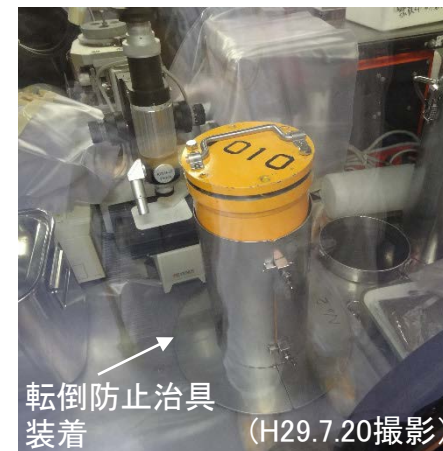
グローブボックス搬入後の貯蔵容器の保管状況
