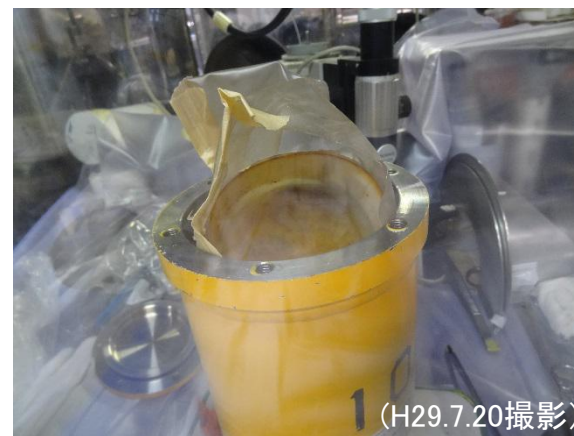
貯蔵容器の状況 (グローブボックス搬入後に確認)
