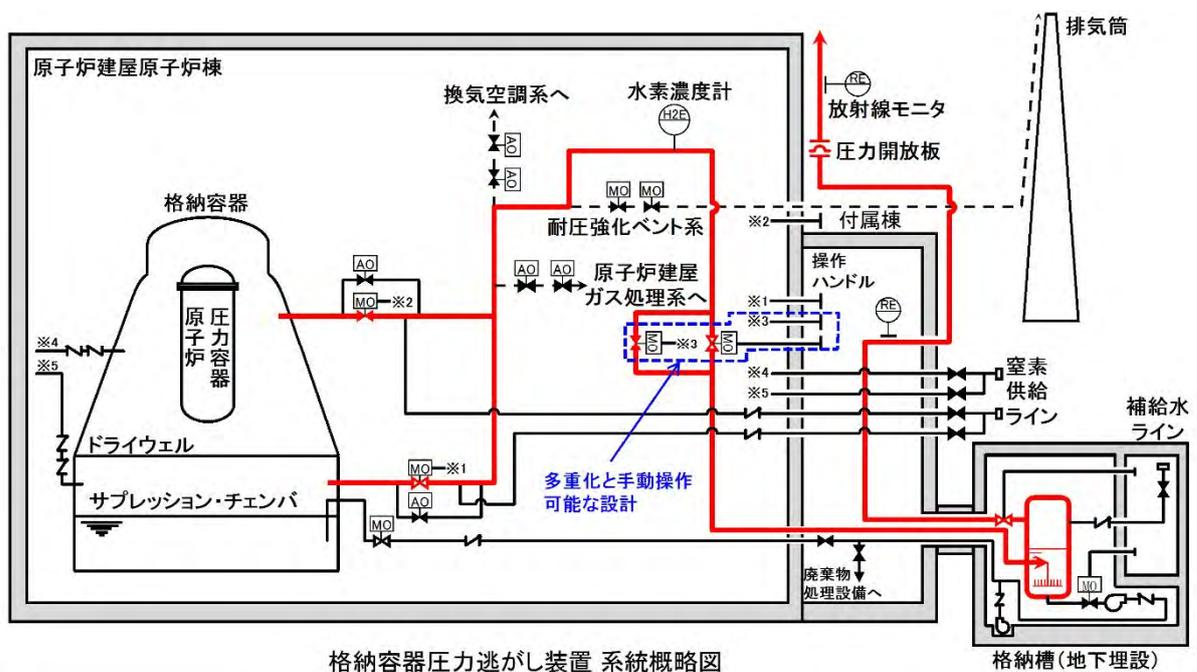
図13.1 原子炉格納容器破損防止対策の概要 (1 / 3)
