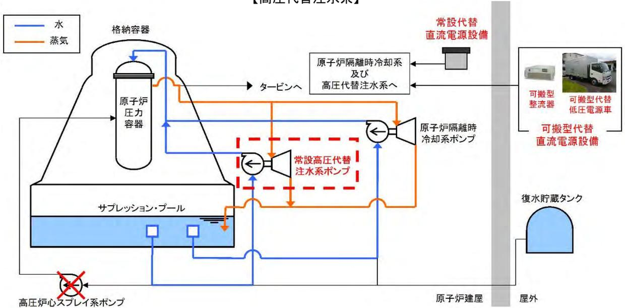
原子炉冷却材圧カバウンダリ低圧時に発電用原子炉を冷却するための設備①
