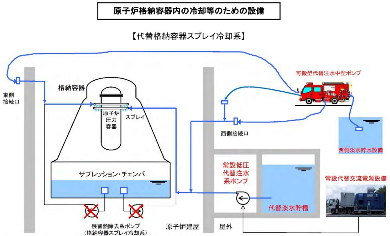
**原子炉格納容器の過圧破損を防止するための設備 ①**
