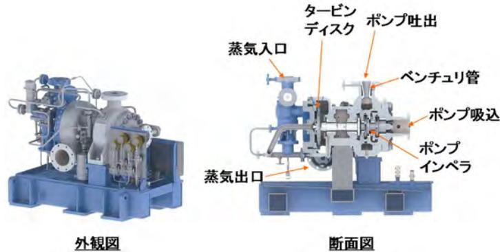
図11.1 常設高圧代替注水系ポンプ構造概要
