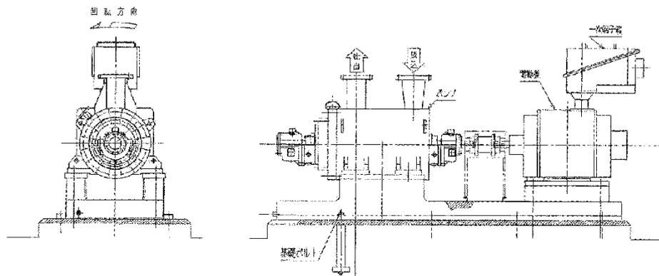
図 15. 2 代替循環冷却系ポンプ構造概要
