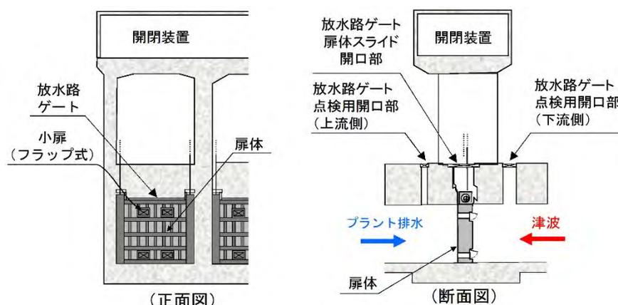
図4.1 放水路ゲート構造概要図
