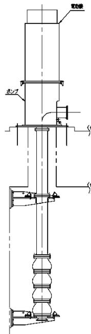
図 1 2 . 1 緊急用海水ポンプ構造概要
