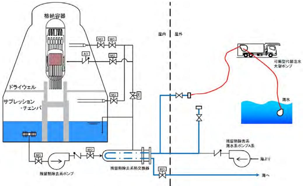
最終ヒートシンクへ熱を輸送するための設備
