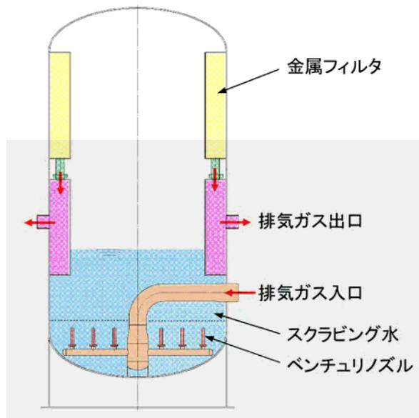
図 1 4 . 2 フィルタ装置構造概要
