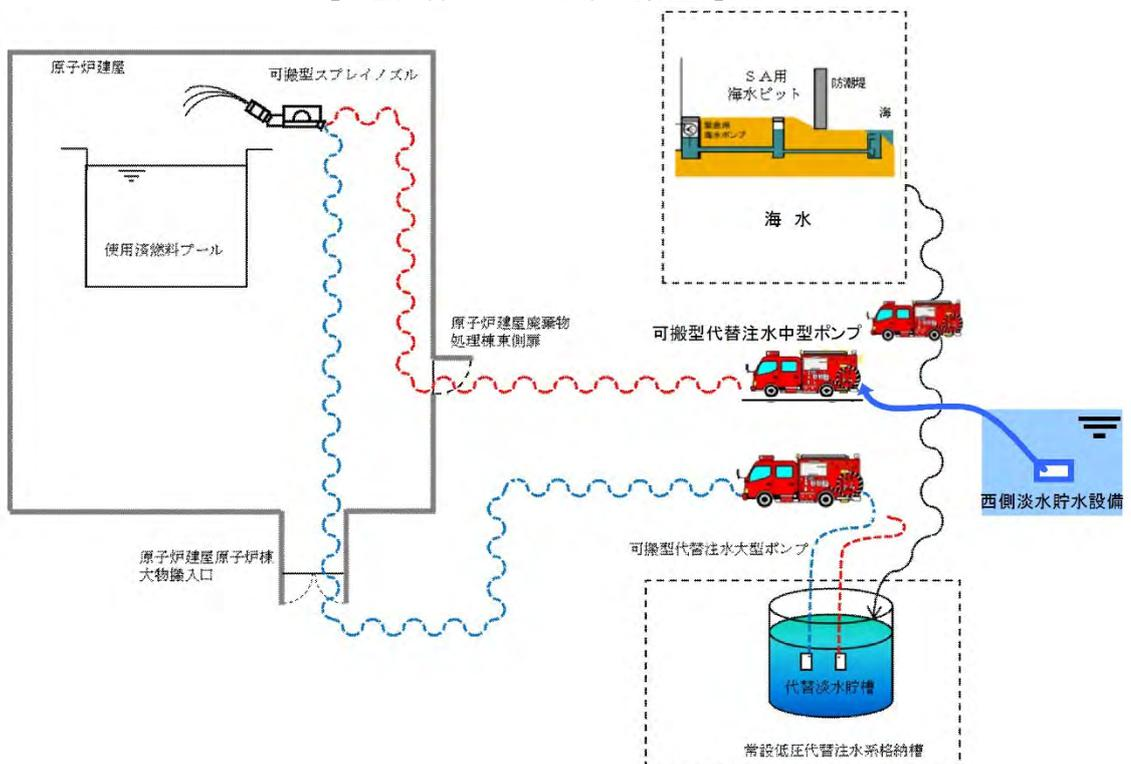
図16.1 使用済燃料プール冷却対策の概要 (1/2)
