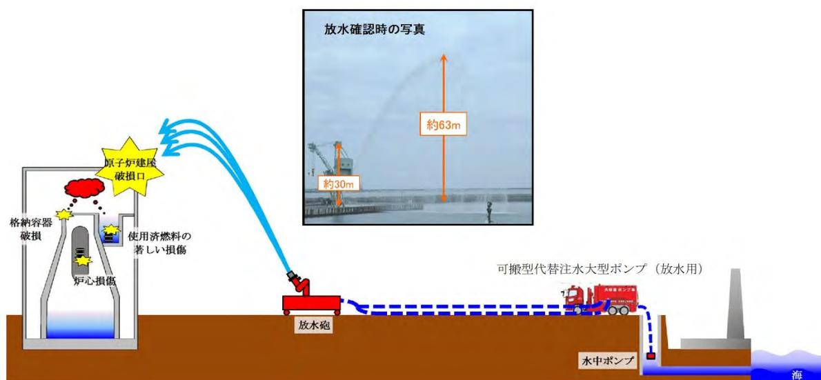
図18.1 放射性物質の拡散抑制対策の概要
