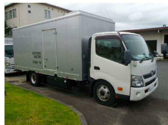
可搬型代替交流電源設備
