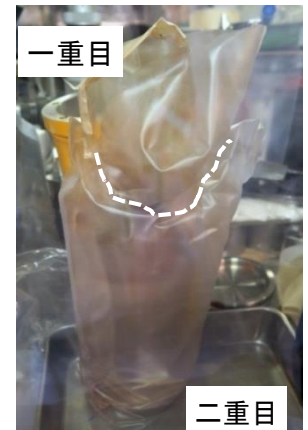
破裂後の一重目と二重目の袋の状態
