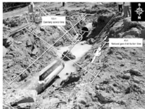
爆発地点のクレーターと破断した配管 論点No.59-13
