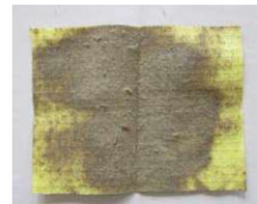
排気筒内面を拭き取った化学雑巾 (主に土埃が付着した)
