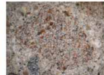
⑤アルカリ骨材反応の点検状況 (実体顕微鏡観察)
