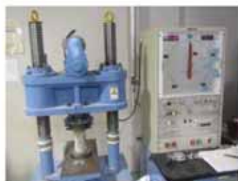
①強度の点検状況 (耐圧試験機による圧縮強度試験)
