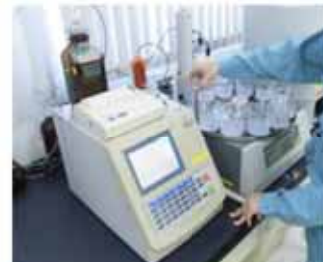
④塩分浸透の点検状況 (塩化物イオン含有量試験)
