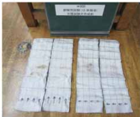
土木シート引張試験供試体(タテ, ヨコ)作成前
