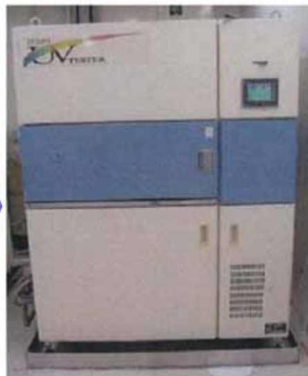
促進耐候性試験機(スーパーUVテスター, 光源装置)
