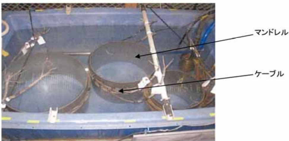
屈曲浸水耐電圧試験状況
