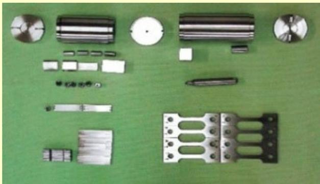
核融合炉材料照射試料
