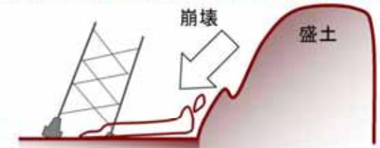
盛土の崩壊に伴う土塊の流れ込みによる鉄塔傾斜, 倒壊
